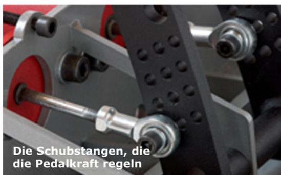
Die Schubstangen, die die Pedalkraft regeln
