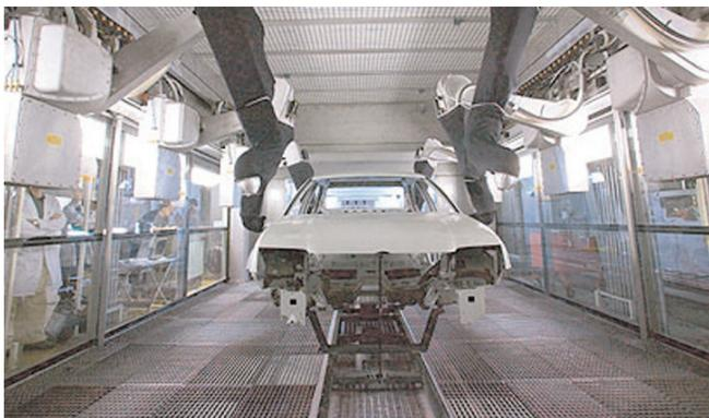
*Flexible Roboter – hier beim Lackieren eines Bora, nach dem Grundlack wird jetzt die Uni, Metallic oder Perleffekt Farbe in der Lackier-Straße aufgetragen*
