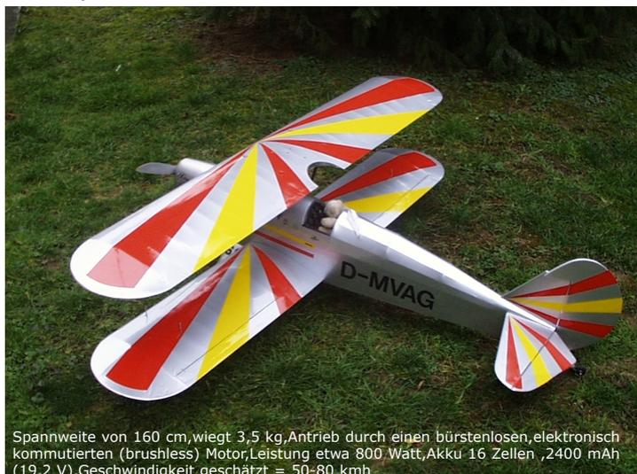
Spannweite von 160 cm, wiegt 3,5 kg, Antrieb durch einen bürstenlosen, elektronisch kommutierten (brushless) Motor, Leistung etwa 800 Watt, Akku 16 Zellen, 2400 mAh (19,2 V), Geschwindigkeit geschätzt = 50-80 kmh
