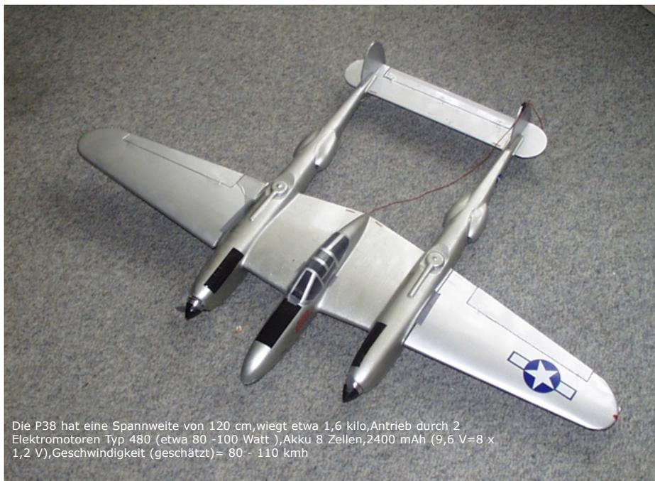
Die P38 hat eine Spannweite von 120 cm, wiegt etwa 1,6 kilo, Antrieb durch 2 Elektromotoren Typ 480 (etwa 80 -100 Watt ), Akku 8 Zellen, 2400 mAh (9,6 V=8 x 1,2 V), Geschwindigkeit (geschätzt)= 80 - 110 kmh
